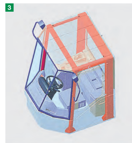
Rollover Protective Structure ROPS 転倒時運転者保護構造 Falling Object Protective Structure FOPS 落下物保護構造
